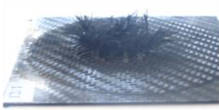
Рисунок 5.7 – Пробой экранирующего слоя РППКМ при воздействии ЭМИ
