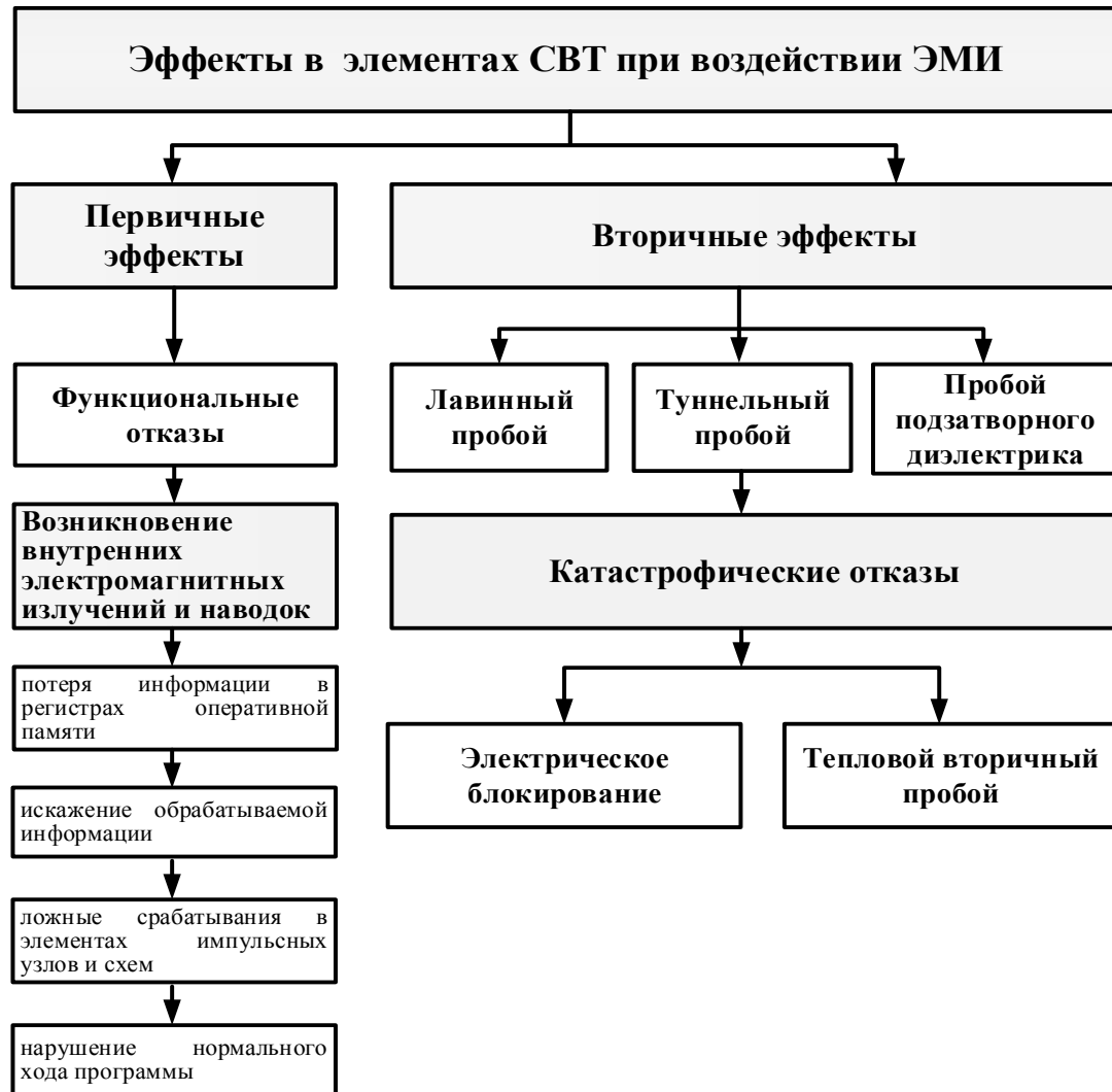
Рисунок 1.15 – Классификация эффектов, возникающих в полупроводниковых элементах СВТ при воздействии ЭМИ
