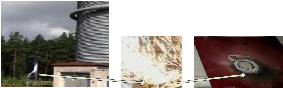
Рисунок 1.23 – Воздействие молнии сгенерированной установкой ГИН-6000/940 TUR на фрагмент электромагнитного экрана
