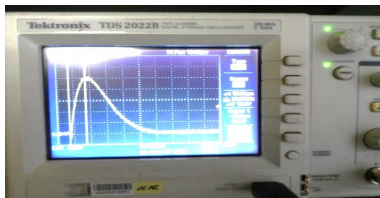
Рисунок 1.22 – Типовая осциллограмма электромагнитного поля сильноточного импульса тока амплитуда 102кА длительностью 4,2 нс, полученные с помощью осциллографа TETRONIXTDS-2022B
