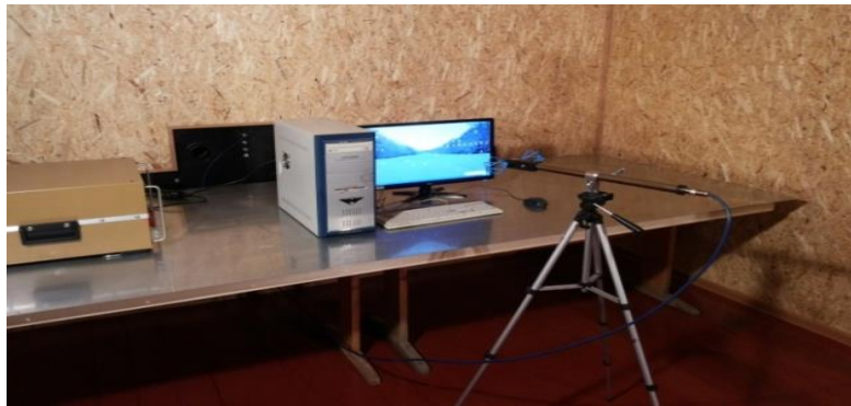
Рисунок 4.25 – Внешний вид экспериментального макета по оценке уровня внутренних электромагнитных излучений и наводок средств вычислительной техники
